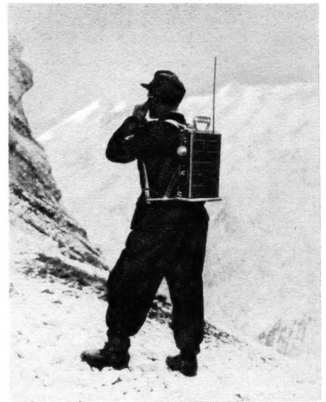
UKW-Sprechfunk als Helfer in Bergnot. Mit dem Telefunken-Teleport verständigen sich die Suchtrupps der Bergwacht bei Lawinengefahren und Bergungsarbeiten, wenn in dem unwegsamen Gelände keine Sichtverbindung besteht
